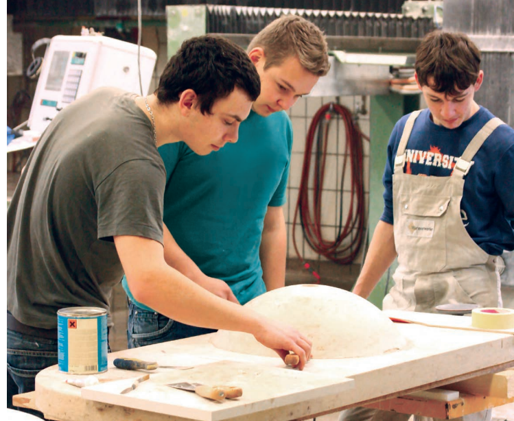
Abb.: Projektarbeit der Naturwerksteinmechaniker - Schüler arbeiten an Kittarbeit einer Waschtischplatte
